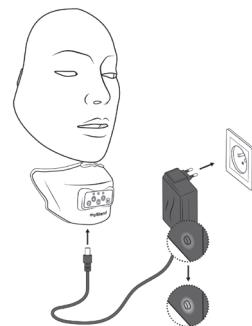
Enchufado a la red eléctrica, se carga en 3H30min, (longitud del cable: 1.800 mm), existen 4 adaptadores específicos, a elegir en función del país.
